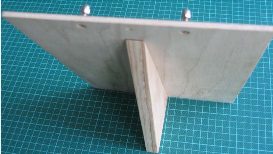
Bild 4 – Dazu wird einfach der Holzkeil mit der längsten Kantenseite und den Spax-Schrauben auf die Rückwand geschraubt (beim Prototyp wurde dazu die Schrauben-Größe 3,5 x 15 mm verwendet), und nun steht das Ganze alleine.
