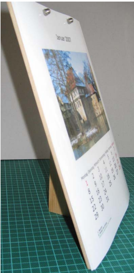
Bild 4 – Dazu wird einfach der Holzkeil mit der längsten Kantenseite und den Spax-Schrauben auf die Rückwand geschraubt (beim Prototyp wurde dazu die Schrauben-Größe 3,5 x 15 mm verwendet), und nun steht das Ganze alleine.
